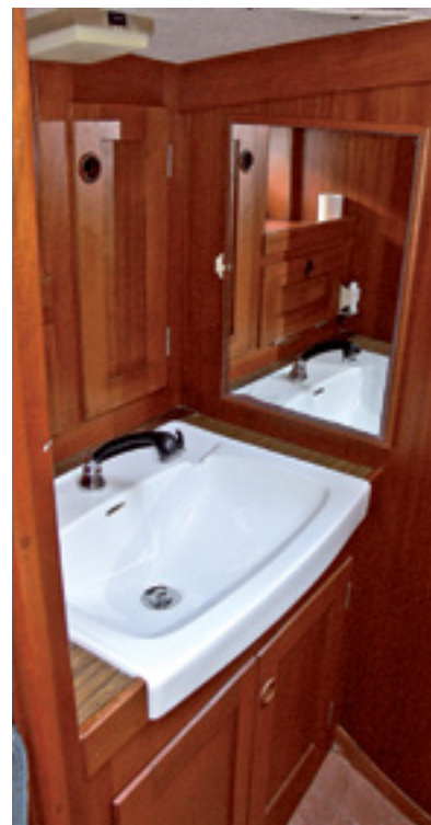
Die Nasszelle verläuft auf dieser MK1 über die gesamte Schiffsbreite. Auf See fehlen allerdings Haltegriffe
