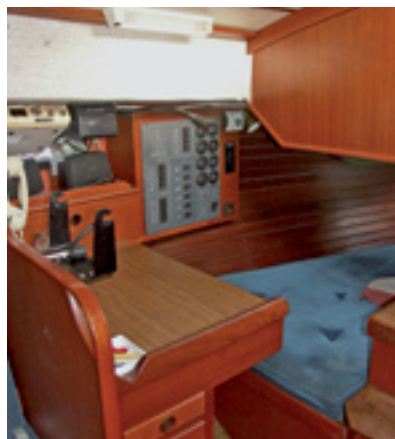
Alle Kojen haben ausreichende Liegelänge, die Schapps darüber sind mit Riegeln gesichert. Zum Schlafen werden die Rückenlehnen hochgeklappt
