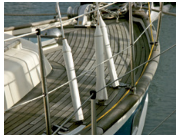
Die Rumpf-Deck-Verbindung wird durch den massiven Teak-Süllrand wirkungsvoll geschützt, die Relingstützen oben auf sind solide verankert
