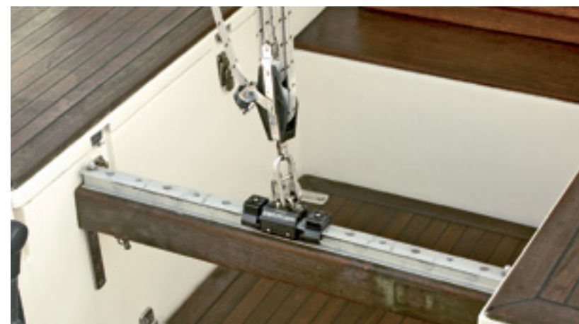
Der Traveller ist für wirkungsvollen Trimm zu kurz und sorgt schnell für angeschlagene Schienbeine. Fahrtensegler können durchaus darauf verzichten
