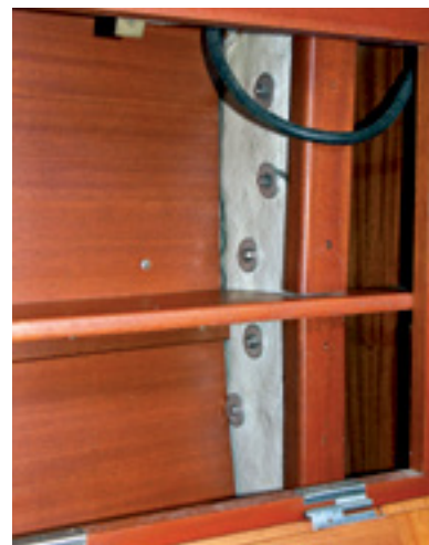
Solide Sache: Die Püttinge sind stabil mit den Rumpfanlamierten GFK-Knien verbolzt
